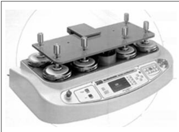
Martindale-Scheuerprüfgerät u.a. zur Prüfung der Scheuerbeständigkeit an Möbelstoffen nach DIN EN ISO12947-2.
